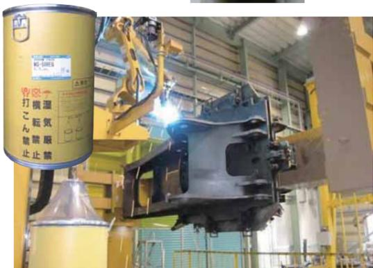
Система сварки для компонентов строительного оборудования
