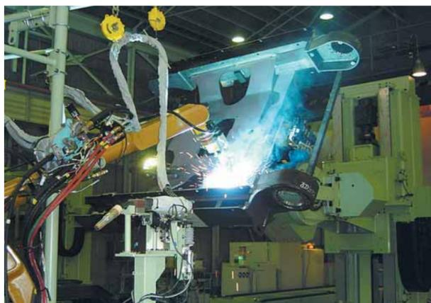
Система роботов для сварки подвижных частей
