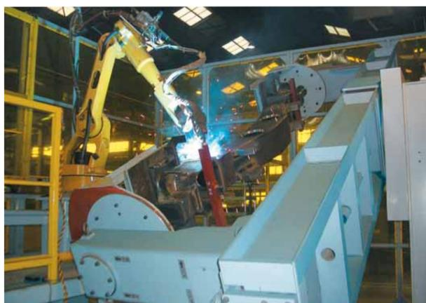
Мост portalного типа панели двойной системой сварки
