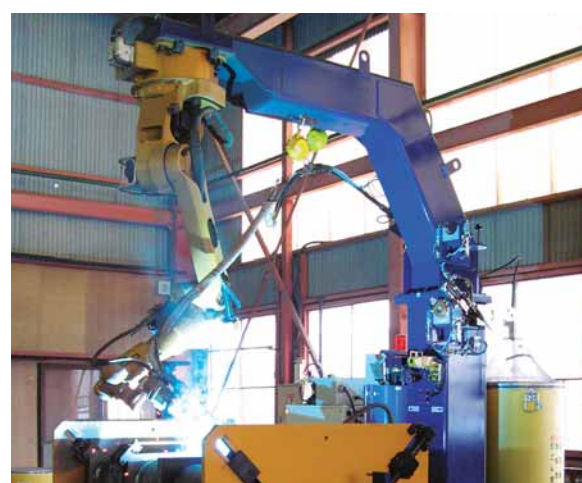
Sistema de soldagem Multitarefa composto por robô na posição reversa Multi-work welding system by reversed hanging robot
