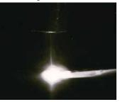
• Наблюдение за поведением расплавленного металла сварочной ванны при вертикальной сварке снизу вверх Observation of Behavior of Molten Pool in the Vertical Up Welding
