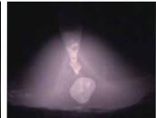
Наблюдение за поведением расплавленного металла сварочной ванны при горизонтальной угловой сварке Observation of Behavior of Molten Pool in the Horizontal Fillet Welding
