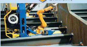
AP-SUPPORT™ позволяет вести отдаленное наблюдение и отслеживать сварочные операции AP-SUPPORT™ enables remote supervision and trace of welding works
