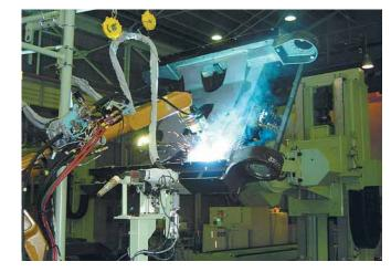
Система роботов для сварки подвижных частей Robot system for welding rolling stock parts
